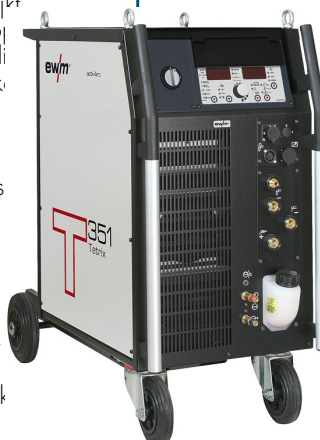
Met de komst van nieuwe ontwikkelingen in de vermogenselektronica, waaronder de toepassing van invertertechnieken, werden de mogelijkheden van de stroombronnen enorm uitgebreid, met als meest opmerkelijke verandering de drastische afname van afmetingen en gewicht voor hetzelfde vermogen van de bron
