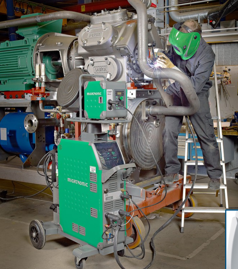
De klassieke lasparameters voor het TIG-lassen kunnen snel en eenvoudig ingesteld worden
