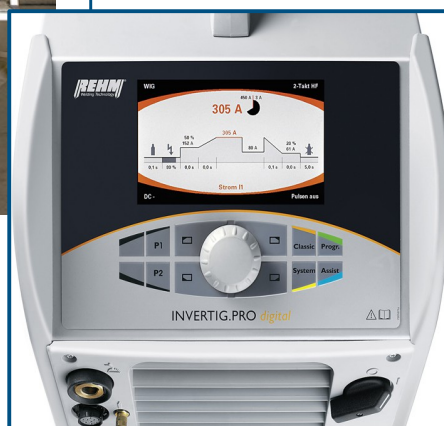
Via grafische displays kan het gebruiksgemak sterk verbeterd worden via intuïtieve schermen, die aangestuurd worden via één knop
